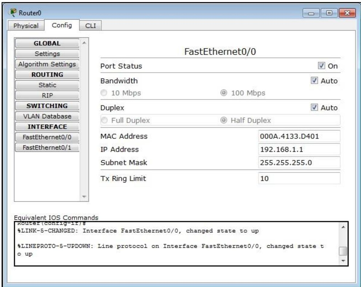
Gambar 3.6 Konfigurasi Router0
