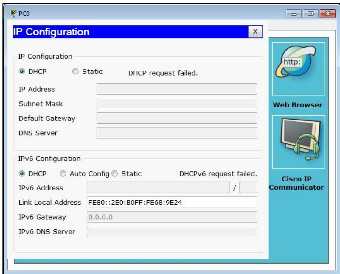
Gambar 5.2 Konfigurasi IP DHCP pada Setiap PC klien
