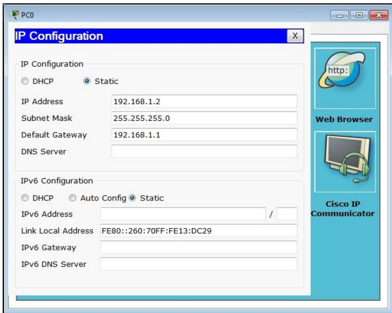
**Gambar 3.4** Konfigurasi IP
